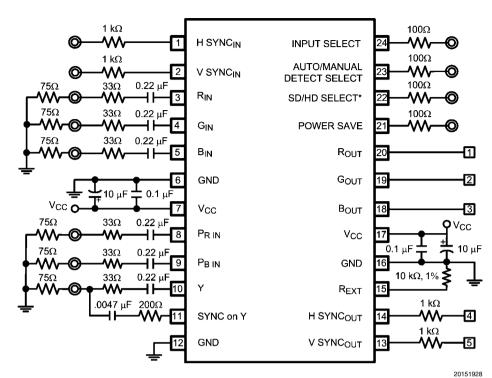
**FIGURE 3. Test Circuit**
