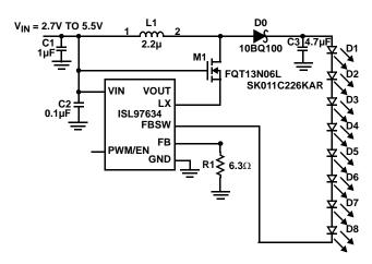
FIGURE 17. CONCEPTUAL 8 LEDs HIGH VOLTAGE DRIVER **SEPIC Operation**
