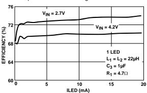
FIGURE 19. EFFICIENCY MEASUREMENT OF A SINGLE LED **SEPIC DRIVER**
