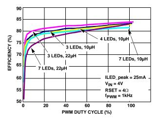
FIGURE 1. EFFICIENCY vs PWM DUTY CYCLE
