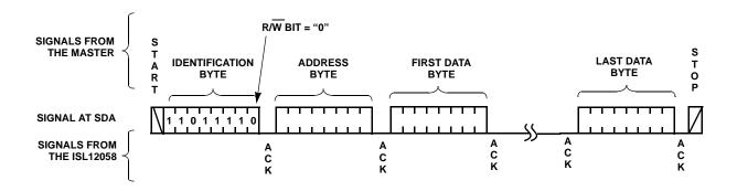
FIGURE 9. SEQUENTIAL BYTE WRITE SEQUENCE
