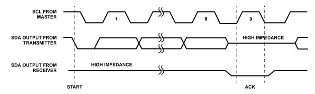
FIGURE 8. ACKNOWLEDGE RESPONSE FROM RECEIVER
