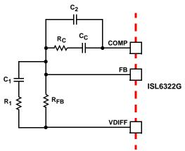
FIGURE 22. COMPENSATION CIRCUIT
