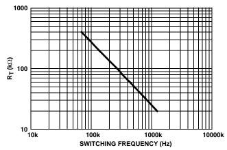
FIGURE 23. R<sub>T</sub> vs SWITCHING FREQUENCY
