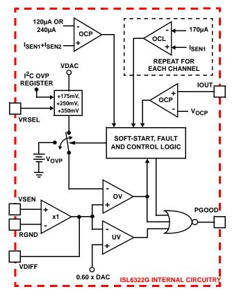
FIGURE 14. POWER GOOD AND PROTECTION CIRCUITRY
