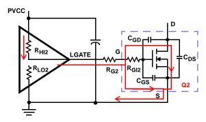
FIGURE 20. TYPICAL LOWER-GATE DRIVE TURN-ON PATH
