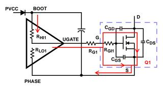
FIGURE 19. TYPICAL UPPER-GATE DRIVE TURN-ON PATH
