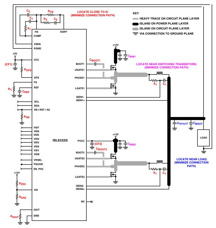
FIGURE 26. PRINTED CIRCUIT BOARD POWER PLANES AND ISLANDS
